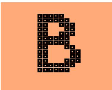
Unsere von der Post geprüften OCR-B Schriften sind als Bitmapped-PCL-Fonts in einer fixen Grösse und Breite im Drucker abgelegt. Eine externe Rasterung entfällt und das Druckbild ist immer identisch.
