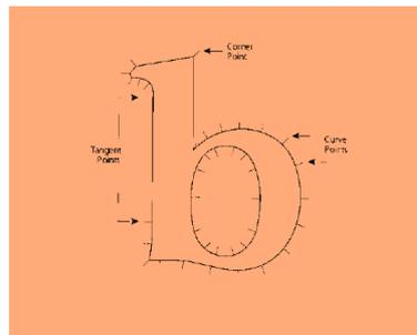
Skalierbare Schriften wie z.B. TrueType oder PostScript Type-1 sind für OCR-B ungeeignet, da diese im PC gerastert und als Grafik gedruckt werden.
